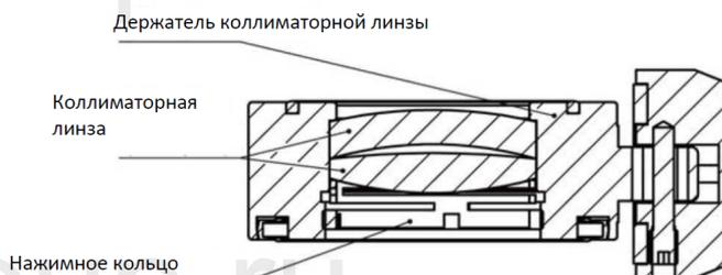
Рисунок 5.6 – Конструкция модуля коллиматорной линзы
