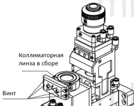
Рисунок 5.5 – Демонтаж модуля коллиматорной линзы
