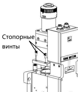
Рисунок 6.3 – Снятие коллиматора
