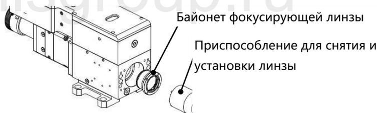
**Рисунок 6.6 – Снятие и установка фокусирующей**
